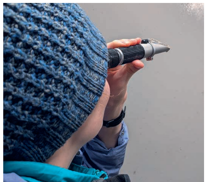
Mit verschiedenen Hilfsmitteln (links ColoastroCheck, rechts Brix-Refraktometer) kann die Kolostrumqualität direkt im Stall bestimmt werden. (Fotos: Christina Widmer)
