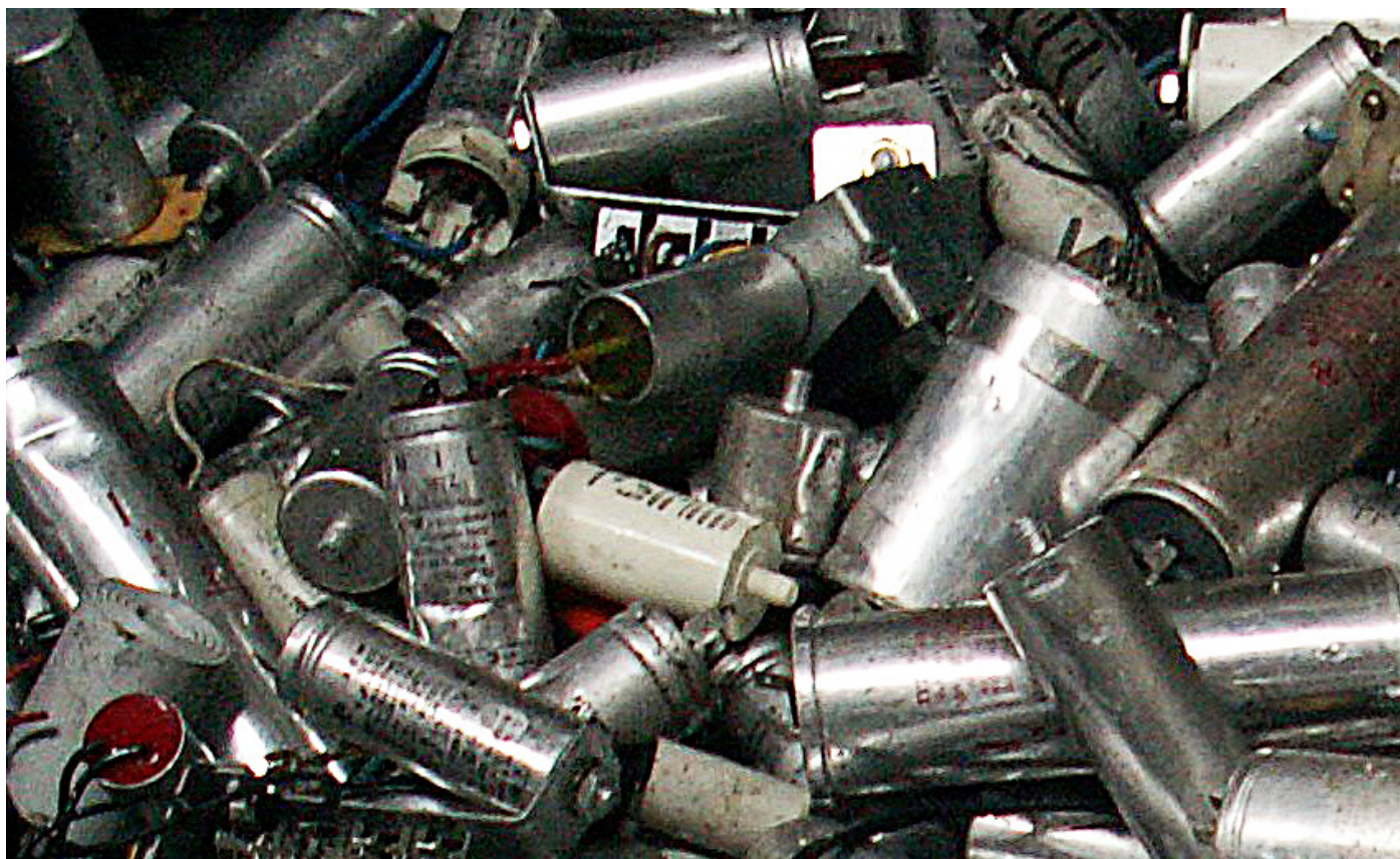
Exemple de condensateurs contenant des PCB pouvant être employés dans des appareils. Photo: EMPA.
