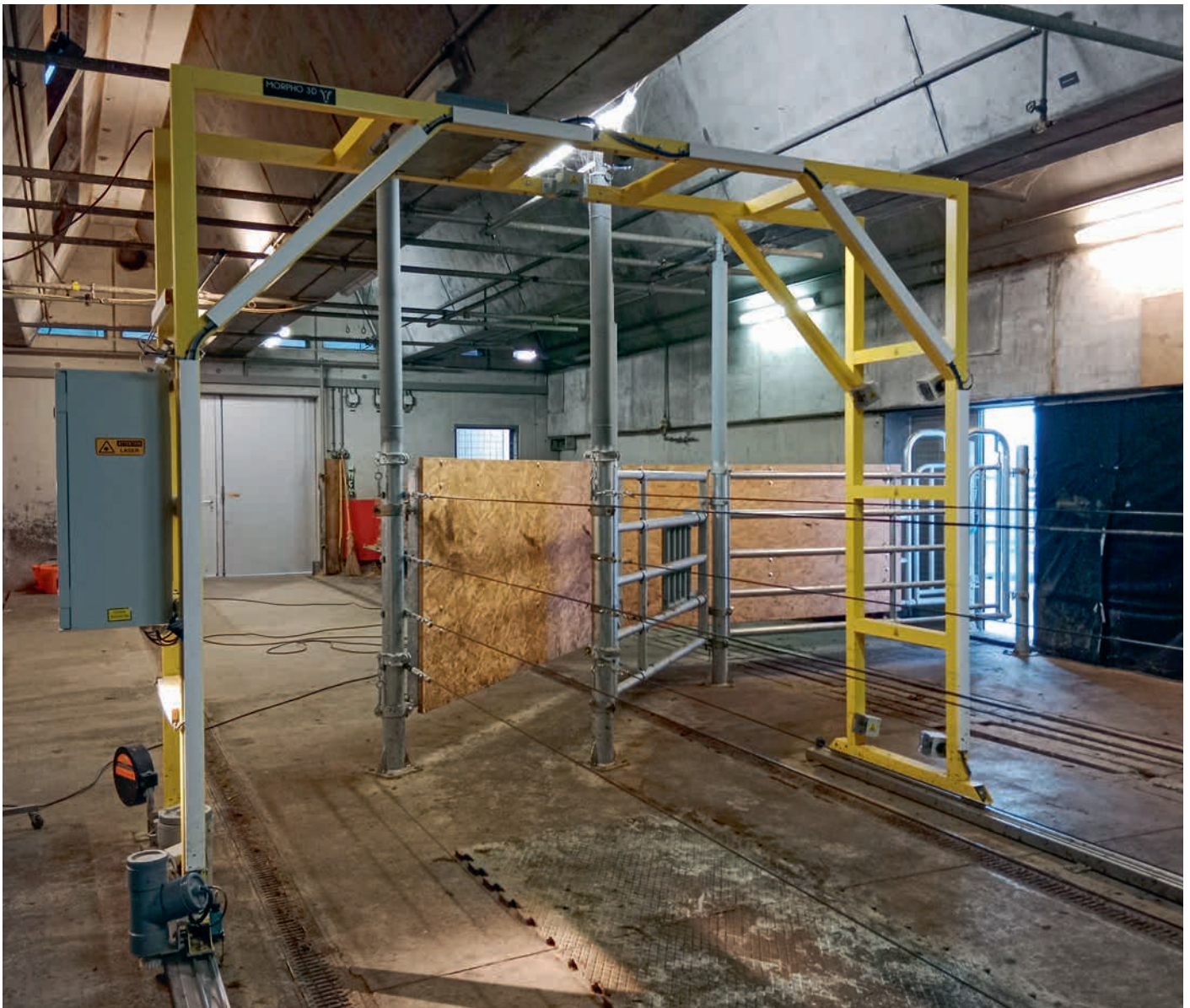
Das Versuchsgesetz Morpho 3D zur dreidimensionalen Erfassung von grossen Wiederkäuern befindet sich am Standort von Agroscope in Posieux. (Foto: Agroscope)
