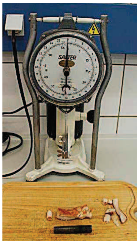
Cet appareil permet de mesurer la résistance au cisaillement, indicative de la tendreté de la viande.
