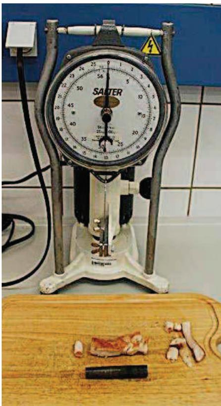
Mit diesem Gerät wird die Scherkraft, ein Mass für die Zartheit des Fleisches, gemessen.
