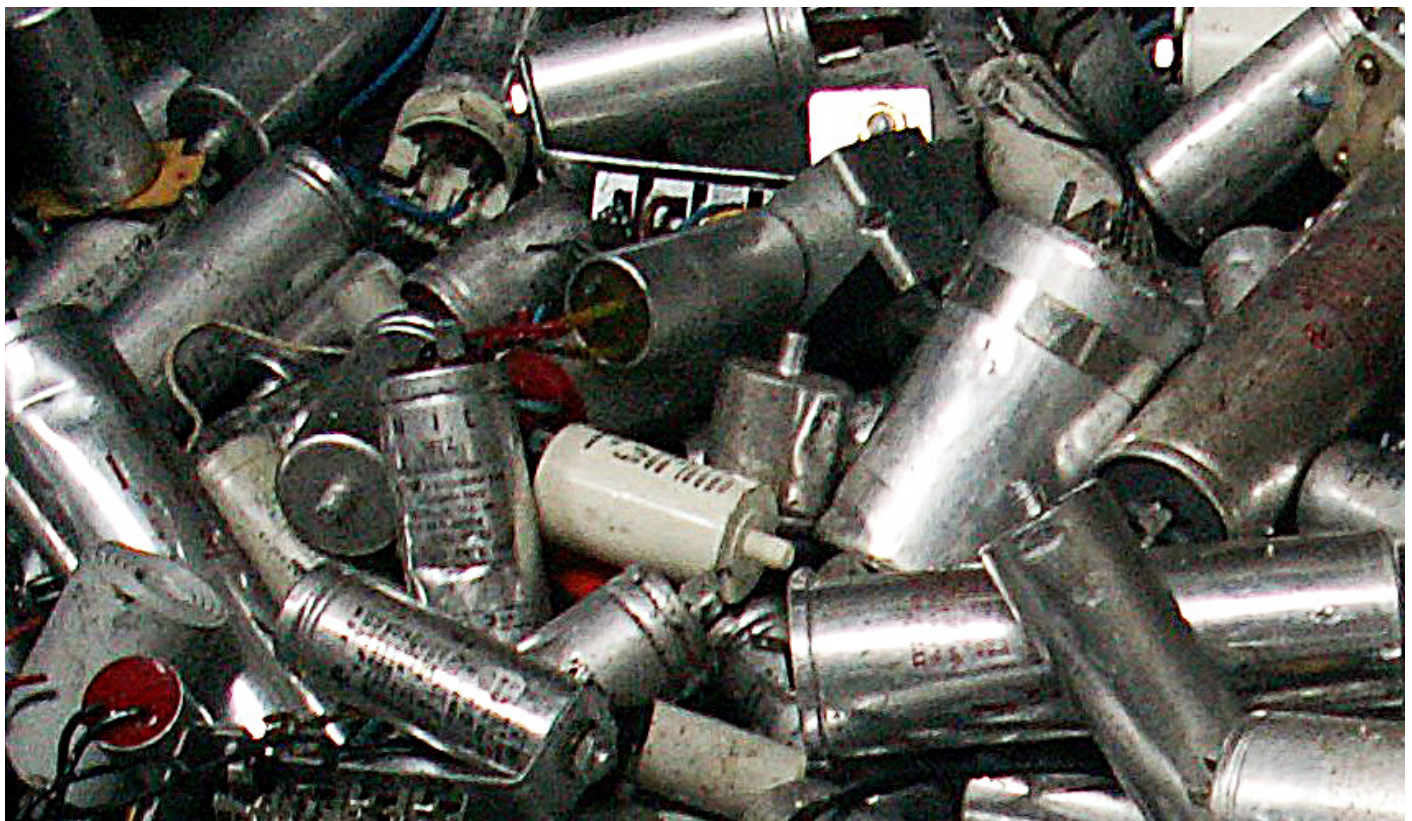
Beispiel von PCB-haltigen Kondensatoren, die in Geräten verwendet werden konnten. Bild: EMPA.
